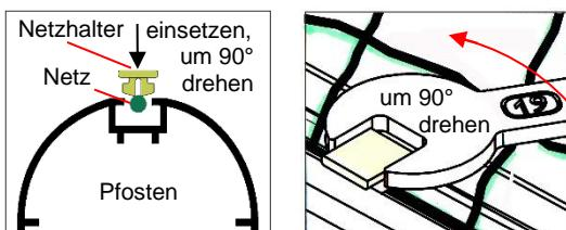
An den Außenpfosten (1) die Netzrandschnur zusammen mit den Netzhaltern (31) in die Profilnut drücken.
