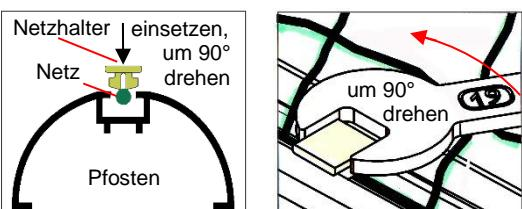
An den Außenpfosten (1) und den Traversen (26) die Netzrandschnur zusammen mit den Netzhaltern (31) in die Profilnut drücken.
