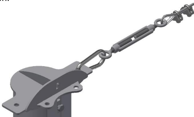
Das Ende des Stahlseils mit dem Karabinerhaken in den zuletzt erreichbaren Pfostendeckel einhängen.
